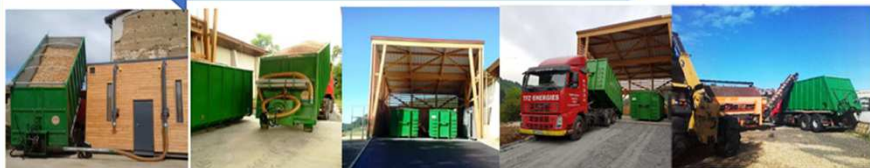
Livraison du combustible bois par soufflage dans le silo de la chaufferie
